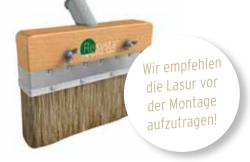
Um ein gleichmäßiges und optimales Farbergebnis zu erzielen, sollte die Lasur bei gleichbleibenden Rahmenbedingungen aufgetragen werden. Deshalb empfehlen wir, die Lasur vor der Montage Diele für Diele aufzutragen. Temperatur ca. 5° - 25°, relative Luftfeuchtigkeit ca. 50 - 60 %.
