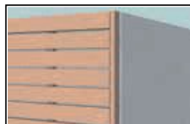
Het afdekken van de holle kamer met eindplaat
